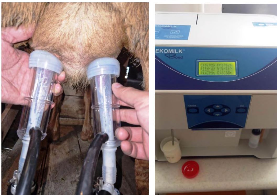
3-сурет - EKOMILK-Bond талдағышында сүттің физика-химиялық құрамын зерттеу
